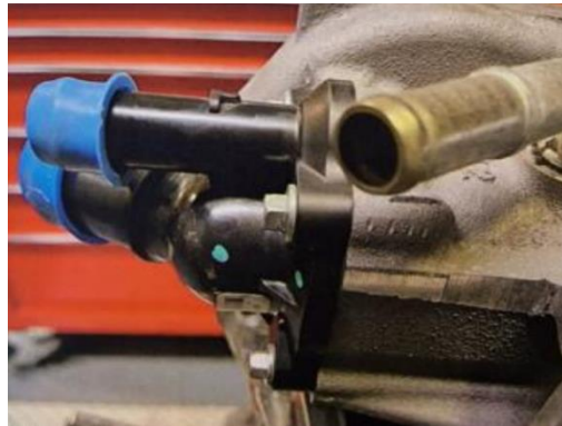
Figura 1 – Detalhe do tubo de refrigeração a tamponar.
